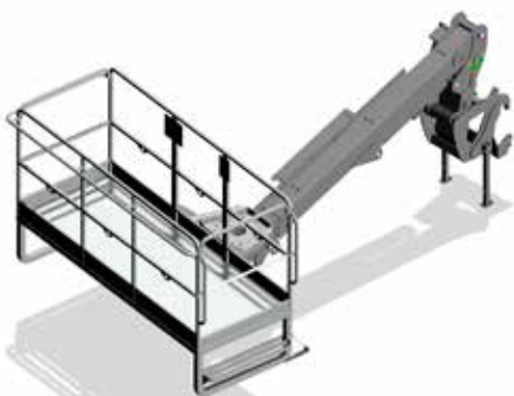
TELESKOPOWA PLATFORMA TP Udźwig: 300 kg
